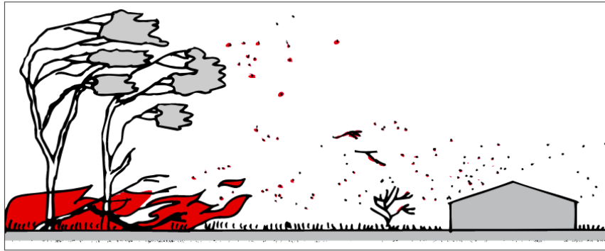
Figura 1: Ataque por fagulhas e/ou partículas inflamadas carregadas com o vento (Ramsay and Rudolph, 2003)
