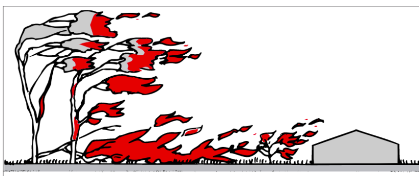
Figura 3: Ataque por chama direta à estrutura (Ramsay and Rudolph, 2003)
