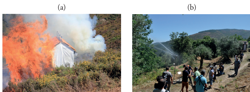
FIGURA 4: Imagens de sistemas de autoproteção: a) ensaios de campo em que uma casa de madeira de pinho sujeita a uma frente de chamas é protegida lateralmente por uma linha de aspersão e frontalmente por uma tela ignífuga; b) linha de aspersores para proteção da aldeia de Travessas, no concelho de Arganil (Coimbra).
