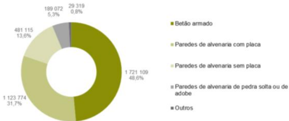
Figura 3 – Caracterização da estrutura dos edifícios habitacionais (Vilhena et al , 2013).
